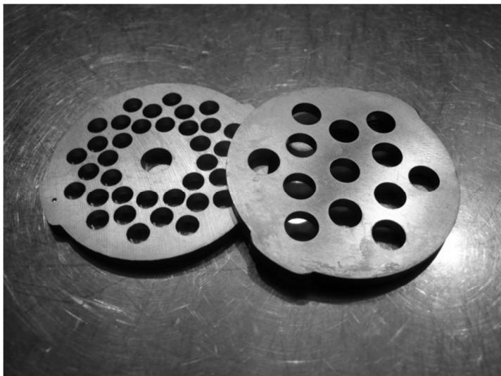
Réalisées à partir d'une bande d'acier non allié contenant 0,2% de carbone de 4 millimètres d'épaisseur. Elle sera découpée, carbonitrurée, trempée revenue pour une dureté maximale, puis rectifiée à 3,5 mm afin de résister à l'usure due au frottement du couteau. L'opération de découpe des grilles s'effectue sur des outillages montés sur presse : poinçonnage des trous de la grille en plusieurs étapes, poinçonnage de la géométrie extérieure de la grille.
