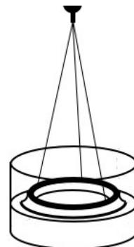
En pesant l'anneau, le dynamomètre indique  $P = 62 \text{ mN}$ . Lorsque l'anneau est immergé dans le bain de nickelage, la force  $F$  d'arrachement est égale à  $79 \text{ mN}$ .
